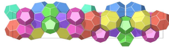
MgNi_2 -55 mol% MgCu_2 (6-layer stack), P6_3/mmc
